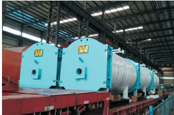
2014.11-0.7MW CWNS0.7-95/70-Q 河南漯河市许慎宾馆
